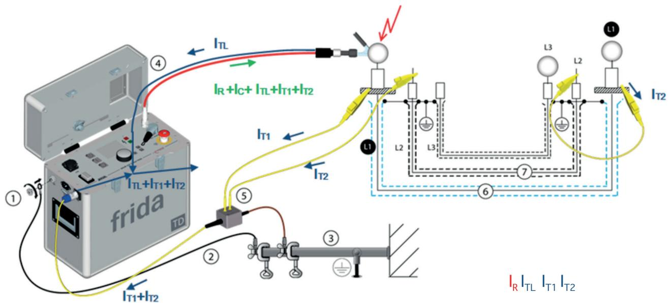
TD Current:  $I_{TD} = I_R + I_C + I_{TL} + I_{T1} + I_{T2} - I_{TL} + I_{T1} + I_{T2} = I_R + I_C$
